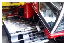
圧雪車 クローラベルト交換
