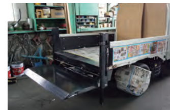
パワーゲート トラックの荷台後部に装着された昇降装置
