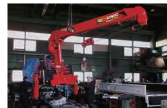
ユニック トラックに装着されたクレーン装置
