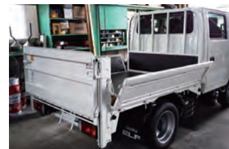
パワーゲート トラックの荷台後部に装着された昇降装置
