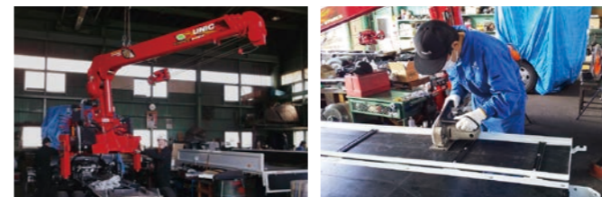
ユニック トラックに装着されたクレーン装置
