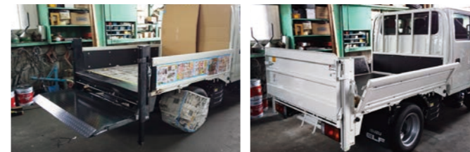
パワーゲート トラックの荷台後部に装着された昇降装置
