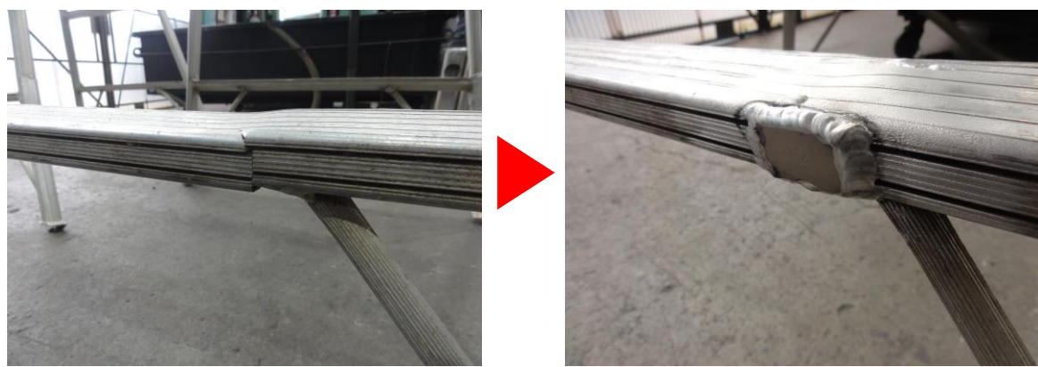
〈修理例：はしご修理〉
